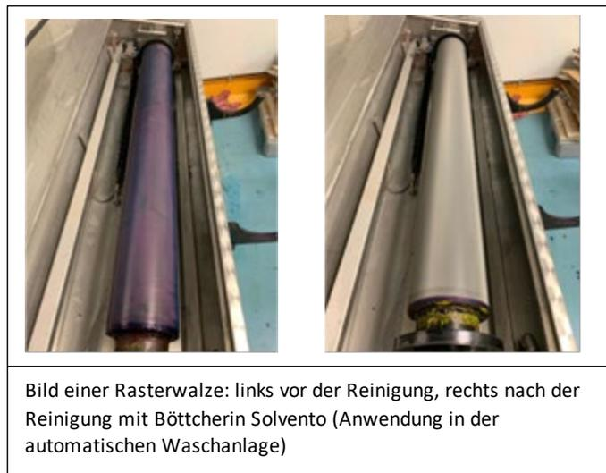
Bild einer Rasterwalze: links vor der Reinigung, rechts nach der Reinigung mit Böttcherin Solvento (Anwendung in der automatischen Waschanlage)
