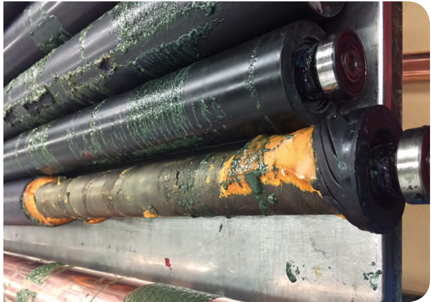
Abbildung 4: Hydrolyse an Polyurethanwalzen nach Einsatz in einer Bogenoffsetmaschine
