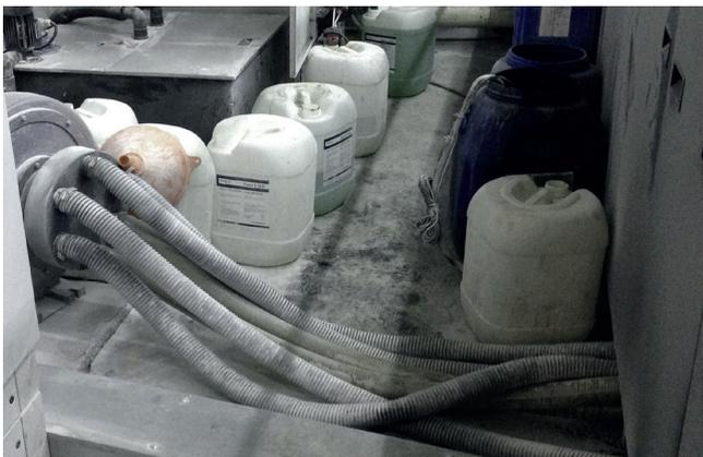
Der Feinstaub setzt sich erst langsam ab und führt zu Verschmutzungen in der Umgebung der Maschine. Feinstaub im Puder trägt nicht zum Druckprozess bei und verursacht nur zusätzliche Kosten.
