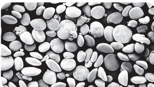
Elektronenmikroskopaufnahme von BöttcherPro Silux 30. Die Puderkörner sind rund, dadurch kein Verkratzen der Oberfläche. Größere Kornfraktionen der natürlichen Stärke werden während des Herstellungsprozesses in mehreren Stufen herausgesiebt. Die Feinstaubanteile werden kontinuierlich durch Absaugen entfernt.
