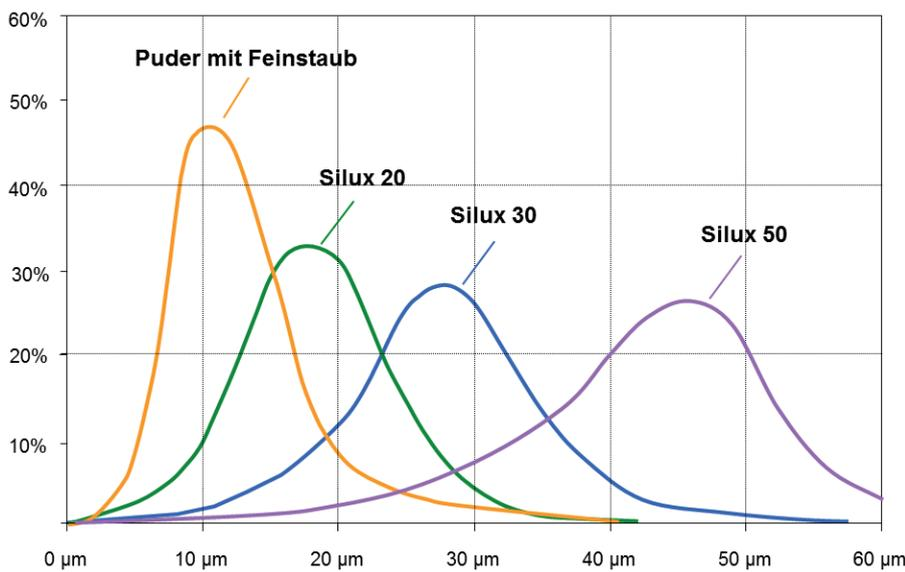
Korngrößenverteilung von Druckbestäubungspuder. Puder mit hohem Feinstaubanteil verschmutzen die Druckmaschine. BöttcherPro Silux-Puder haben nur einen sehr geringen Feinstaubanteil unter 10 µm.
