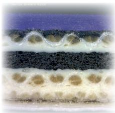
Selbstklebendes Drucktuch für den Hohlkörperdruck (Dosen, Sprays, Alutuben, usw...) im Trockenoffset mit konventionellen Farben. Der Kleber wird direkt auf das Rückseitengewebe aufgetragen und ist somit ein Bestandteil des Drucktuches im Gegensatz zu vielen Tüchern, wo der Kleber in der Form eines doppelseitigen Klebebandes von 0,25 mm auf ein 1,70 mm dickes Tuch kaschiert wird. Der Kleber hinterlässt beim Abziehen keine Rückstände auf dem Zylinder.
