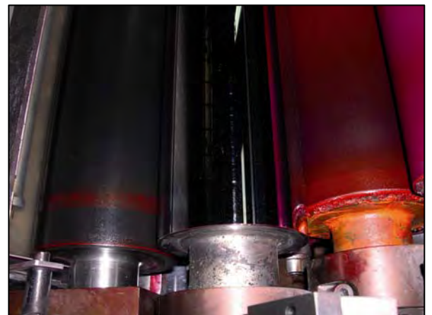
Bild 1: Farbrückspaltung auf die Feuchttauchwalze (links)
